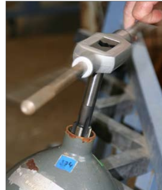
...und anschließend nachgeschnitten, um Grate zu entfernen. Beides ist bei Prüfungen eher unüblich, gehört jedoch ins Pflichtprogramm.
