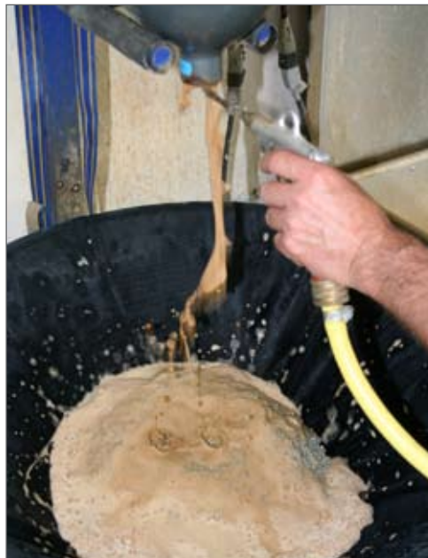
Nach der Reinigung zeigt sich der „Geist der Flasche“: Rost, Fette, Schmutz.
