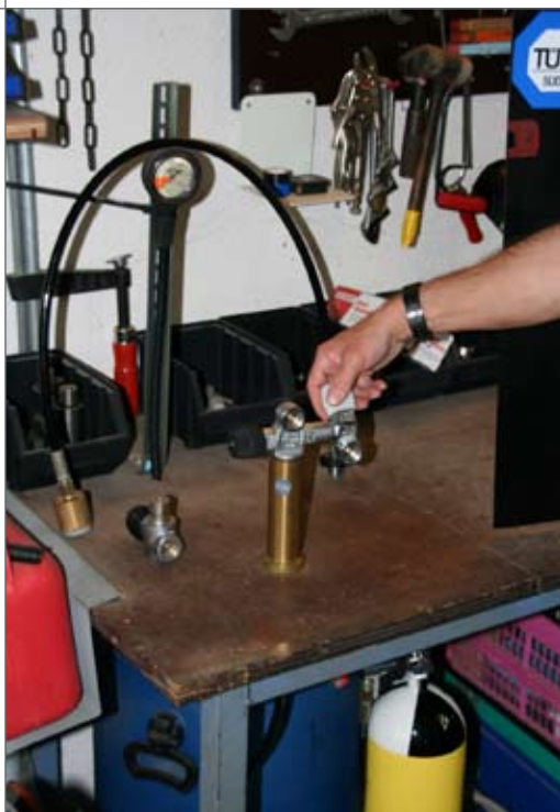
...gereinigt und auf Undichtigkeiten untersucht.
