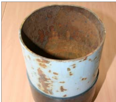
Diese Flasche wurde aus dem Verkehr gezogen - Instandsetzung und Prüfung waren nicht mehr möglich.
