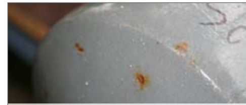
Äußere Korrosion im Bereich des Standfußes, eine Folge die mit dem richtigen Standfuß nicht passiert wäre.
