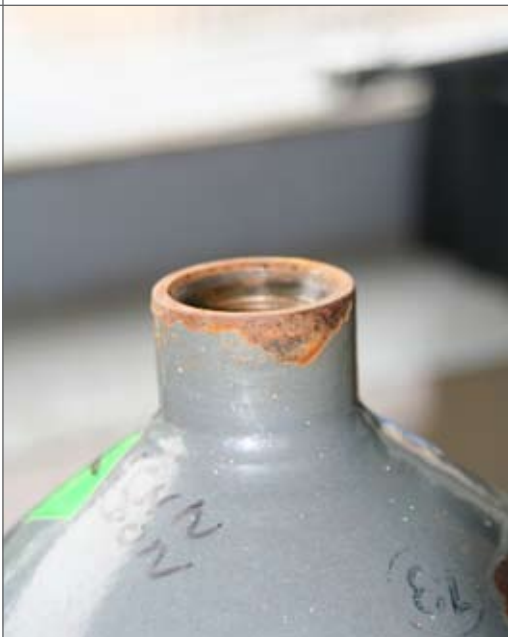
Rost am Rand des Flaschenhalses - kein Verschulden des Tauchers, sondern schlampiger Umgang beim „Flaschen-TÜV“.
