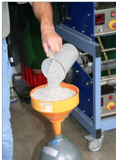
Die einzelnen Bestandteile des Reinigungssubstrats werden in einem bestimmten Mischungsverhältnis in die Flasche gefüllt. Die Menge ist abhängig von der Flaschengröße.
