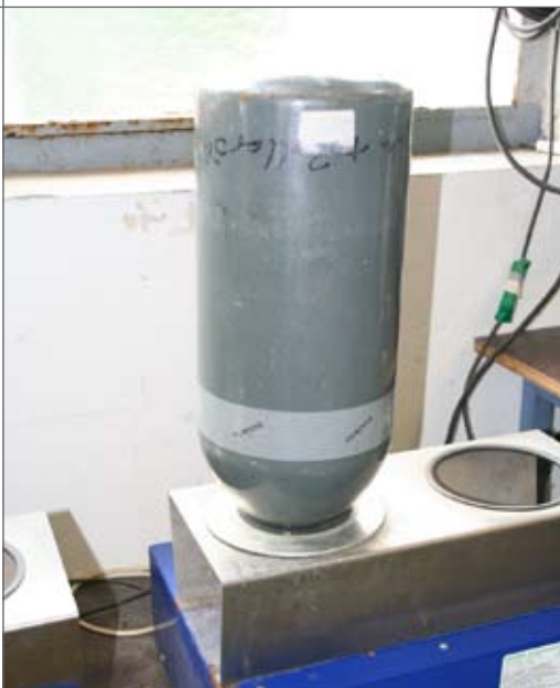
Das Ende der Reinigung ist die vollständige Trocknung. Oftmals nicht praktiziert oder bei falscher Temperatur. Alu-Flaschen bedürfen niedrigerer Temperaturen als Stahlflaschen.
