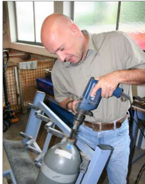
Peter Schreiner von Scuba Sicherheitstechnik bei der Fleißaufgabe: Die Gewindegänge werden gereinigt...
