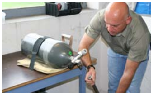
Peter Schreiner von Scuba Sicherheitstechnik baut die Flaschen mit dem vorgeschriebenen Anzugsdrehmoment zusammen. Möglich ist dies nur mit einem Drehmomentschlüssel. Die Flasche ist wieder gut verpackt auf der Werkbank eingespannt
