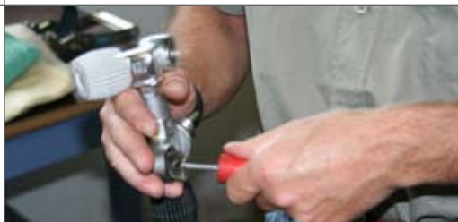
Auch das Gewinde des Flaschenventils wird in Augenschein genommen...
