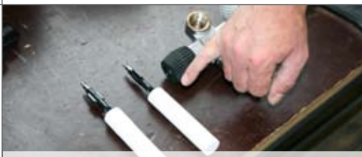
In der Zwischenzeit wird das Flaschenventil instandgesetzt, beispielsweise der Filter erneuert.
