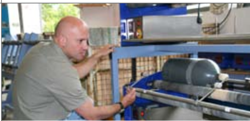
Fingerspitzengefühl beim Einstellen der Drehzahl: Die Flasche wird anschließend eine lange Zeit gerollt und dadurch innen gereinigt.
