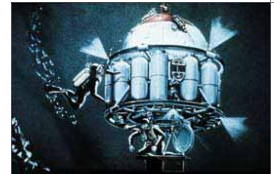
Transfer- und Dekompressionskapsel - ähnlicher Aufbau wie Kellers „Atlantis“ © OAR/National Undersea Research Program (NURP); U.S. Navy
